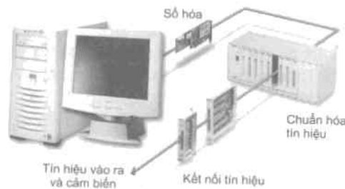
HÌNH 50.3 Phần cứng đo lường của hệ thống thu thập dữ liệu dựa trên PC
