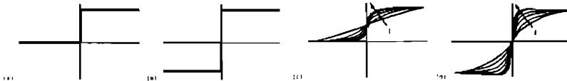
HÌNH 32.4 Các hàm kích hoạt điển hình: (a) hàm đơn cực ngưỡng cứng, (b) hàm lưỡng cực ngưỡng cứng, (c) hàm đơn cực liên tục, (d) hàm lưỡng cực liên tục
