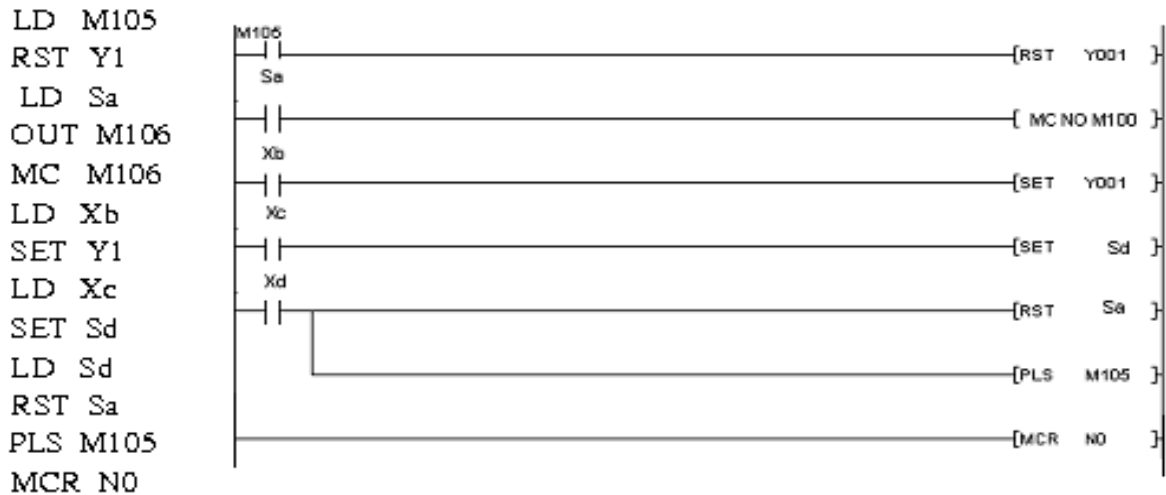
Hình 2.32: Cơ chế Stepladder – (a): Mạch cơ bản STL; (b): Mạch tương đương dùng lệnh cơ bản
