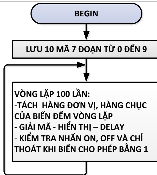
Hình 5-53: Lưu đồ đếm có điều khiển bằng nút nhấn Start-Stop.
